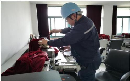
修当中，此时此刻的他正聚精会神的对炉膛压力开关进行校验确保万无一失。
